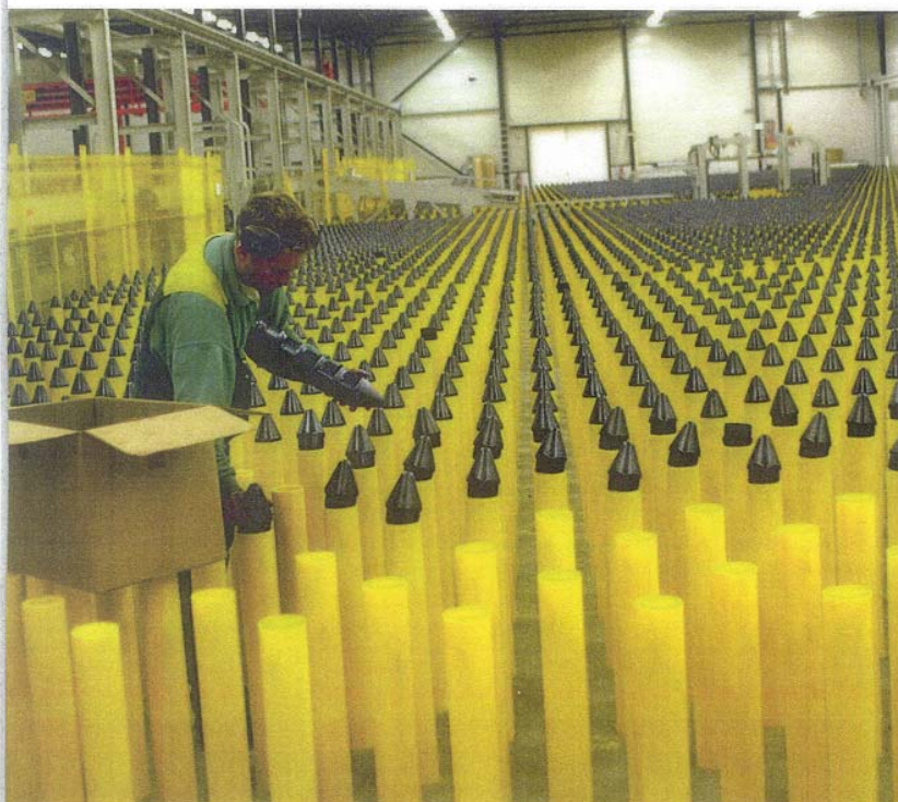
Kees Kramer van De Jong Betonboringen voorziet de 13.000 nieuwe pinnen van zwarte kappen
